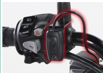
LED シャトルビームの ON/OFF スイッチは左ミラー共締です。
